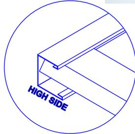
チャンネルとパネルの両端は揃っている必要がありますが、スナップタイトシステムはチャンネルを押しただけできれいに揃うまで調整することができます。
