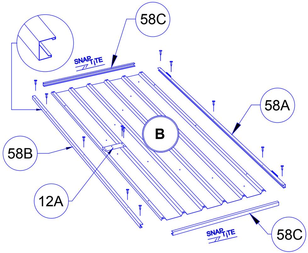
ドア部分の縦に取り付けるチャンネルは、他の横向きに取り付けるチャンネルの向きと逆に取り付けます。
