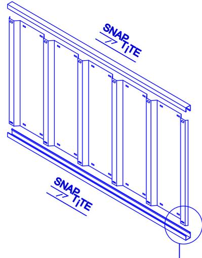
4枚の壁パネルと2枚の屋根パネルを組み立てる際は各組立詳細ページの「SNAPTITE」マークの表示に従って各パネルの上部と下部を固定させます。
