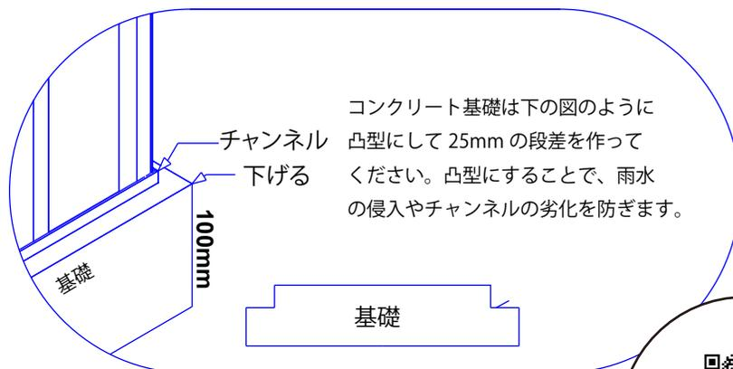
コンクリート基礎は下の図のように凸型にして25mmの段差を作ってください。凸型にすることで、雨水の侵入やチャンネルの劣化を防ぎます。
